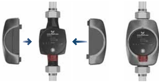
6. ábra A szivattyúház szigetelése
